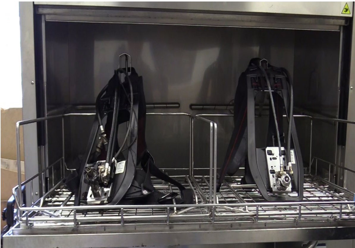
Bild 5. Bärställ tillhörande andningsapparater efter förbehandling och diskning i tankdiskmaskin med BA Decon.
